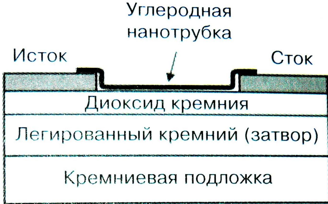
**Полевой транзистор на основе углеродной нанотрубки.**
